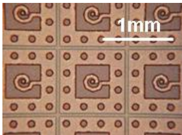
ノイズの伝搬をカットするEBG構造 (EBG: Electromagnetic Band Gap)
